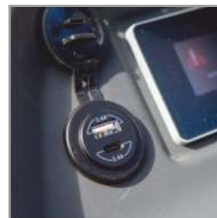
USB PRIKLJUČAK ZA PUNJAČ Na komandnoj ploči nalazi se USB-A i USB-C priključak za punjač koji svaki isporučuje maksimalno 2,4 A.
