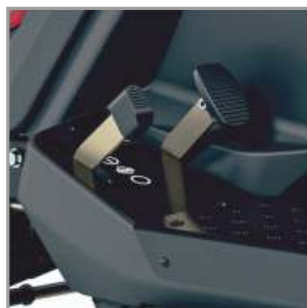
BLOKADA DIFERENCIJALA Omogućuje bolju trakciju u skliskim uvjetima (SYC122).
