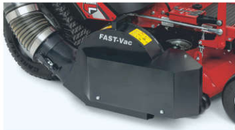
Velik promjer izlazne cijevi od 18 cm
