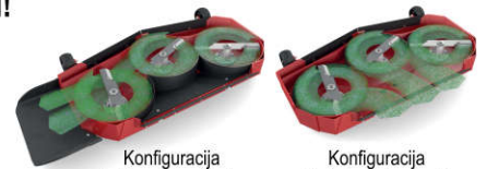
Konfiguracija bočnog izbacivanja
