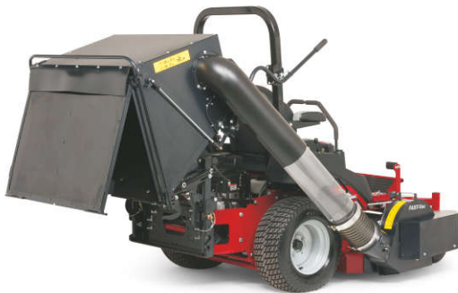
Velik promjer izlazne cijevi od 18 cm
