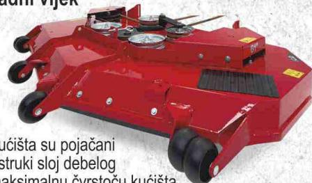
iCD™ sustav košnje omogućuje bolji protok zraka i daje superiornu kvalitetu košnje. Rubovi kućišta su pojačani gdje je najpotrebni. Dvostruki sloj debelog čeličnog lima osigurava maksimalnu čvrstoću kućišta. Štitnici na ležajevima remenica štite ih od vlage i prijavštine čime im produžuju vijek trajanja. Sva rezna kućišta su opremljena snažnim, 6 mm debelim Marbain® čeličnim noževima.
