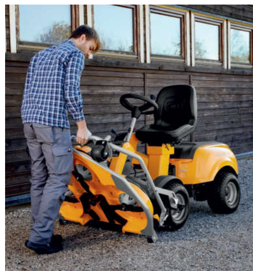
PARK 320 G Stiga ST 450, 432 cm 3 , 8,10 kW, 95-105 cm, hidrostatski prijenos.
